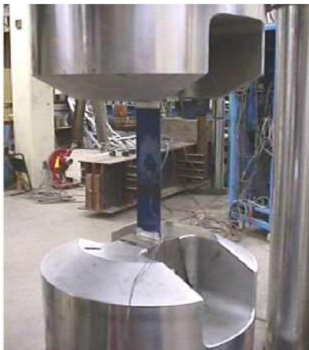
Esecuzione del test secondo ASTM D3039
