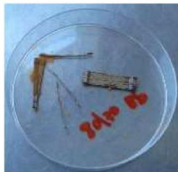
Fibre corrodibili, prova non superata
